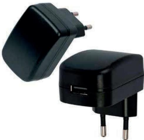
Carregador universal com conexão para cabos USB, entrada bivolt de 100 a 240VAC, 50/60Hz, 0.5A, e saída USB 5VDC, 1A.
