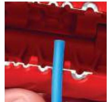
Auxiliar de posicionamento prático facilita a inserção de condutores individuais para descarnar
