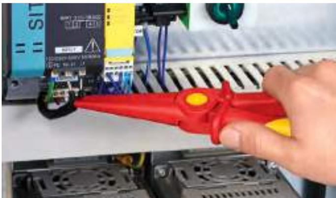
Com os alicates de plástico de alta qualidade e estáveis, a KNIPEX apresenta duas ferramentas à prova de ligação em ponte, para uso em peças sob tensão de até 1000V AC e DC 1500V.
