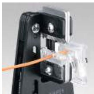
12 12 02 com guia de cabo e encosto de comprimento
