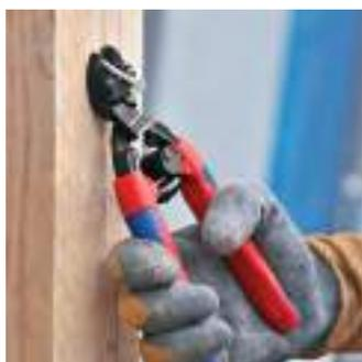
Cabeça com angulação de 20° com patilha de um lado e corte lateral para um corte alinhado; com espaço livre para pegar
