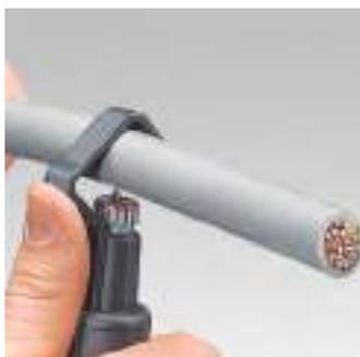
Colocação da ferramenta para corte de perímetro
