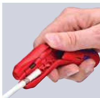
A retirada de capa de um cabo coaxial
