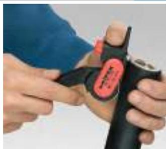
Colocação da ferramenta para o corte longitudinal
